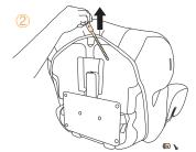
Снимите рычаг регулировки наклона, как показано на рисунке.
