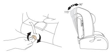
Для регулировки угла наклона спинки автокресла поворачивайте круглый рычаг (рычаг регулировки наклона).
