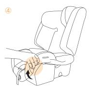
Снимите чехол подголовника движением снизу вверх. Не вынимайте пеноуретановый элемент. Готово!
