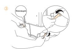
Приподнимите чехол автокресла с обеих сторон, как показано на рисунке, и, взявшись ключами с обеих сторон, поверните любой из ключей против часовой стрелки для ослабления винта. (Ключ с другой стороны позволяет избежать полного прокручивания)
