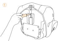
Положите автокресло на спинку нижней частью к себе и с помощью крестообразной отвертки ослабьте винт рычага регулировки наклона.
