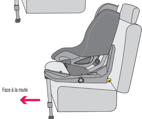
Retirez les fixations Isofix (6) en tournant la molette (9) située sur le côté du socle. Le pied anti-rotation (12) se dépliera de lui-même.
