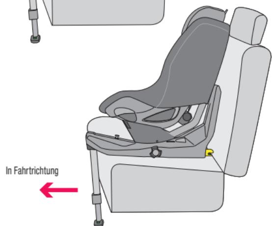
Ziehen Sie die Isofix-Halterungen (6) heraus, indem Sie den Knauf (9), seitlich am Grundgestell drehen. Der Stützfuß (12) klappt durch Schwerkraft auf. **1.a**
