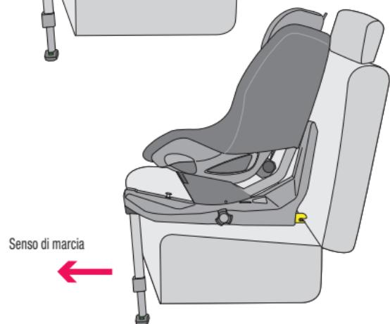
Estrarre gli ancoraggi ISOfix (6) girando il pomello (9) che si trova sul lato della base. La barra anti-rotazione (12) si apre per gravità. ①.a
