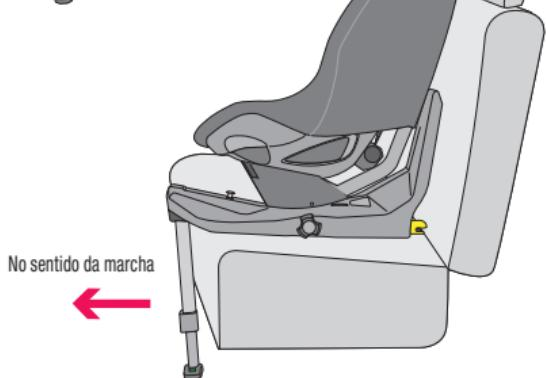
Extraia os fixadores ISOfix (6) girando a extremidade (9) situada na parte lateral da base. O pé anti rotação (12) desdobra-se com a gravidez. **1.a**
